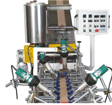
Tutkallanmış Malzemenin Ürüne Yapıştırıcılığını Arttıran Sıcak Hava Tabancaları The Hot Air Duster Guns is Increased the Adhesion of Glued Materials to the Product
