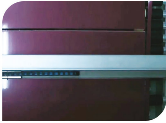
Folyoyu Birleşme Noktasından Keserek Panelleri Birbirinden Ayıran Sistem The Partition System for Panels Cutting Foil from Merger Point
